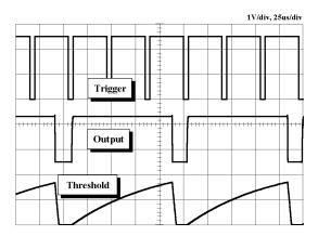
$R_A=9.1k\Omega$ ,  $R_L=1k\Omega$ , C1=0.01uF, Vcc=5V
