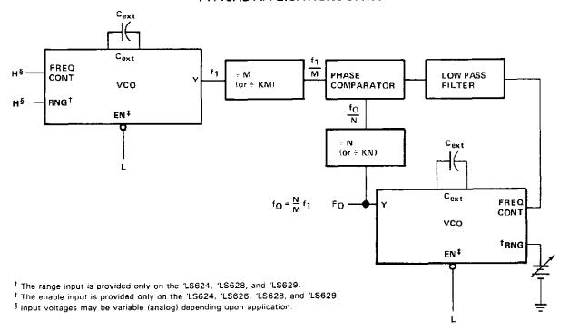
FIGURE A-PHASE-LOCKED LOOP
